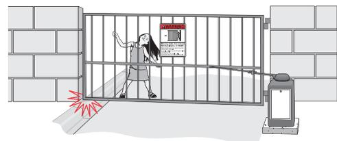
Un corps étranger se trouve sur le cadre de la barrière pendant le mouvement de barrière.
