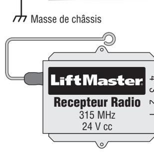
Faisceau de câblage de radio
