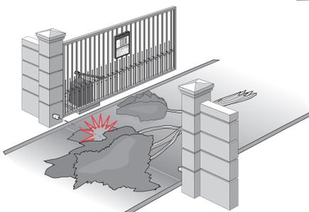
Un dispositif de protection contre le piégeage branché à l'extérieur se déclenche à deux reprises (le capteur photoélectrique est bloqué).
