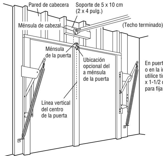
En puertas sin marco expuesto o en la instalación opcional, utilice tirafondos de 5/16 de pulg. x 1-1/2 de pulg. (No incluidos) para fijar la ménsula de la puerta.
