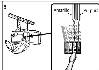
Para insertar o soltar el cable, empuje la lengüeta hacia dentro con la punta de un destornillador.
