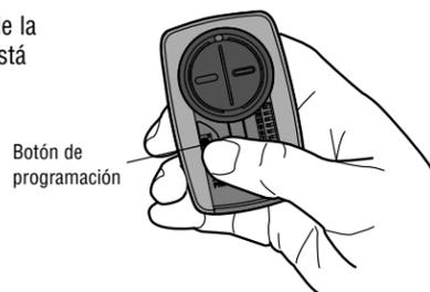
**2** Para abrir el control remoto, deslizando la tapa hacia abajo. Oprima y suelte el botón de programación hasta que se encienda el LED (aproximadamente 2 segundos).
