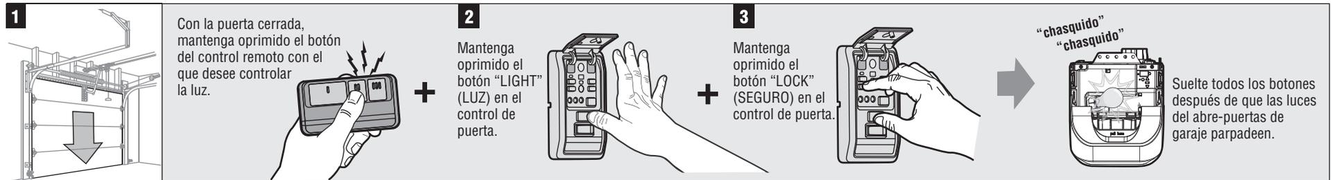
Pruebe oprimiendo el botón "control remoto". Las luces del abre-puertas de garaje deben encenderse o apagarse, pero la puerta no debe moverse.
