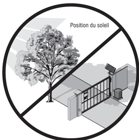
**CONSEIL :** La zone entourant l'emplacement des panneaux solaires doit être libre de toute ombre ou obstruction au soleil pour un rayon de 180° d'est en ouest.
