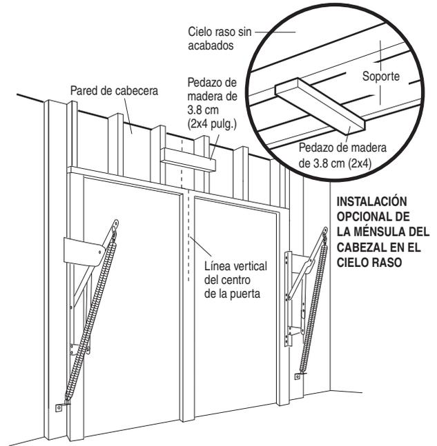
**INSTALACIÓN OPCIONAL DE LA MÉNSULA DEL CABEZAL EN EL CIELO RASO**
