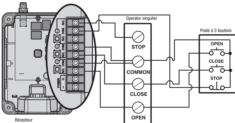
Consulter les schémas de câblage de l'ouvre-porte ou de l'ouvre-portail pour obtenir des instructions sur la connexion de deux ou plusieurs télécommandes à 3 boutons.
