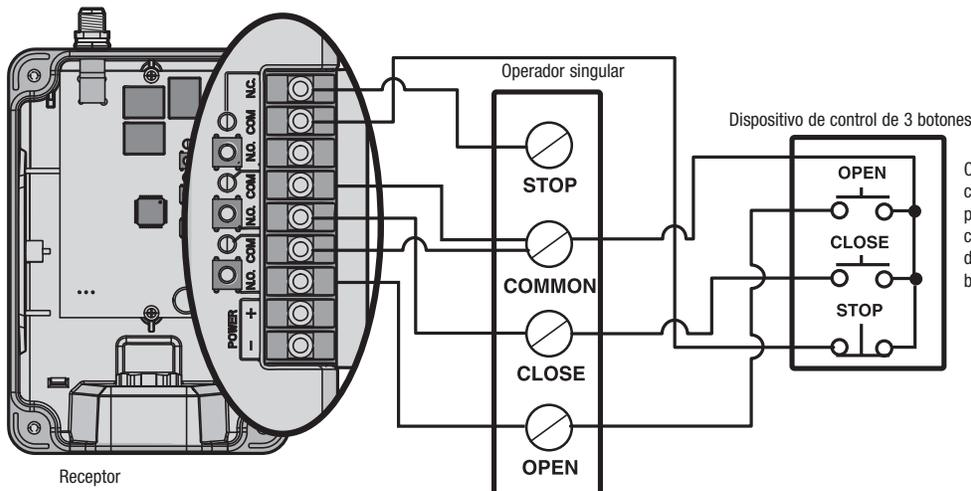
Consultar los diagramas de conexiones del abrepuerta para determinar las conexiones de dos o más dispositivos de control de 3 botones.
