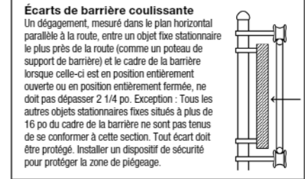
DIRECTIVES D'OUVERTURE DE BARRIÈRE COULISSANTE FIGURE 3
