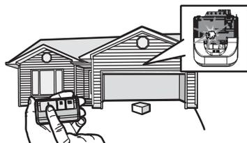
El abre-puertas no ejecutará el cierre con comando remoto si la luz indicadora de cualquiera de los sensores de seguridad estuviera apagada (advirtiendo al usuario que los sensores están desalineados o hay una obstrucción).
