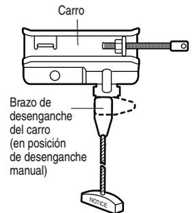
**Posición de bloqueo (desconexión manual)**
