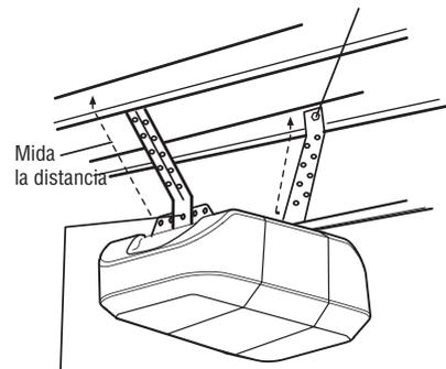
Perno de 5/16-18x7/8 de pulg., Arandela de presión de 5/16 de pulg., Tuerca de 5/16-18 de pulg.
