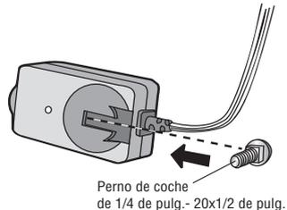
**1.3A** Introduzca el perno en el orificio de la ménsula de sensor y fije con tuercas mariposa. Las lentes de ambos sensores deben quedar enfrentadas entre sí. Asegúrese de que la lente del sensor no quede tapada por la ménsula.
