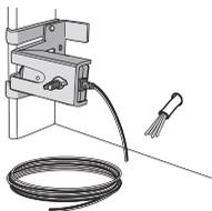
**2.2B** Separe los conductores del par y quite 11 mm (7/16 de pulg.) de aislamiento en cada uno. En dos de los cables preinstalados quite 11 mm (7/16 de pulg.) de aislamiento en cada uno. Elija el mismo color de cable preinstalado para cada sensor.
