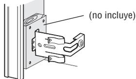
**1.2B** Taladrar los orificios de 3/16 de pulgada de diámetro por cada ménsula de sensor y sujete las ménsulas de sensor al pared con tornillos tirafondos (no incluye).
