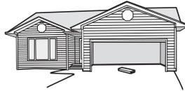
**2.2** Oprima el botón en el control remoto para cerrar la puerta. La puerta DEBE entrar en reversa automáticamente al hacer contacto con la obstrucción.
