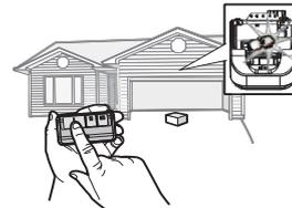
El abre-puertas no ejecutará el cierre con comando remoto si la luz indicadora de cualquiera de los sensores de seguridad estuviera apagada (advirtiendo al usuario que los sensores están desalineados o hay una obstrucción).
