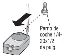
**1.4C** Introduzca el perno en el orificio del ménsula de sensor y fijar con tuercas mariposa. Las lentes de ambos sensores deben quedar enfrentadas entre sí. Asegúrese de el lente del sensor no quede tapado por la ménsula.
