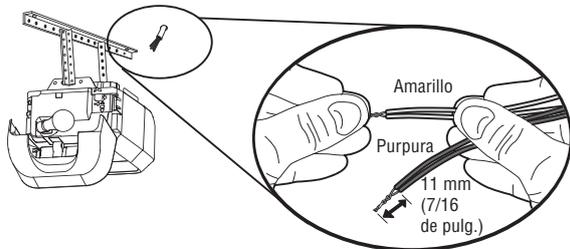
**2.5B** Introduzca los cables conectado a los cables por el sensor de seguridad blanco al el terminal blanco en la abre-puertas de garaje. Introduzca los cables conectado a los cables por el sensor de seguridad blanco/negro al el terminal gris en la abre-puertas de garaje.
