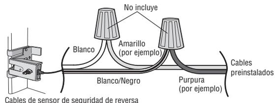
**2.4B** En la abre-puertas de garaje, pele 11 mm (7/16 de pulg.) de aislación en cada extremo de los cables por los sensores de seguridad de reversa. Retuerza juntos los cables de colores similares.
