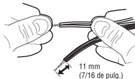
**2.3A** Conectar los cable blanco a los terminale blanco del abre-puerta de garaje. Conectar los cable blanco/negro a los terminale gris del abre-puerta de garaje. Para conectar o desconectar un cable, empujar la pestaña con la punta de un destornillador.
