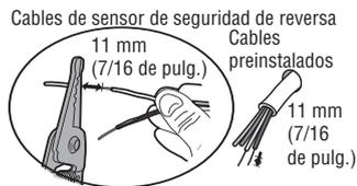
**2.3B** Conecte al sensor los cables preinstalados, usando capuchones de empalme. Verifique que los colores sean los que correspondan a cada sensor. Por ejemplo, el cable blanco es conectado al cable amarillo y el cable blanco/negro es conectado al cable púrpura.
