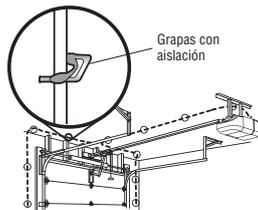
**2.2A** Quitar 11 mm (7/16 de pulg.) de aislamiento de un extremo del cable. Separar los cables. Retuerza juntas los cables blancos. Retuerza juntas los cables blancos/negros.
