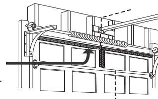
Se necesita un refuerzo horizontal y vertical (no incluido) para puertas de garaje livianas (fibra de vidrio, aluminio, acero, puertas con panel de vidrio, etc.).
